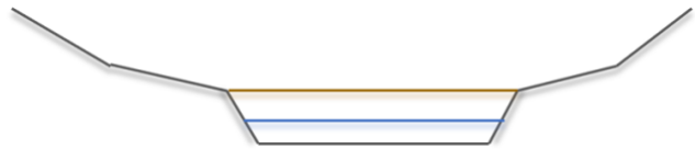
Abbildung 3-9: Schema des Gerinnes sowie des Biberdammes im Chriesbach.
