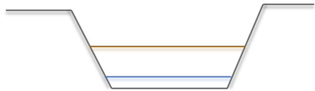
Abbildung 3-6: Schema des Gerinnes sowie des Biberdammes im eingetieften Kanal des Tegelbachs.
